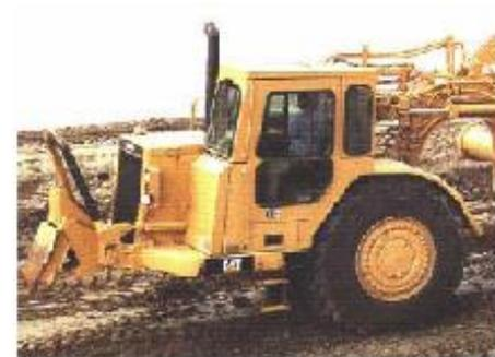
**b) Máquinas Operatrizes** - São aquelas que acionadas pelas máquinas motrizes realizam diretamente o trabalho. Ex.: scraper, escarificadores, compactadores.
