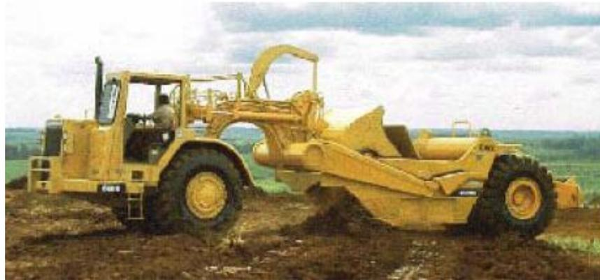
O moto-scaper é um dos equipamentos responsáveis pela viabilização da utilização maciça da terraplenagem mecanizada. O que possibilitou a diminuição do preço do m<sup>3</sup> transportado foi o invento do **pescoço**, que, quando o moto-scaper está em movimento, transmite aproximadamente **60% do peso da carga** para a roda motriz, conseqüentemente aumentando a **aderência**, possibilitando a utilização de grande **potência usável**.
